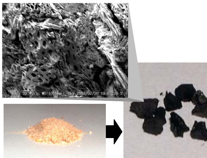
図1. ホットプレス炭素化法を用いることによりおがくずから高強度で密度の高い活性炭の製造に成功
