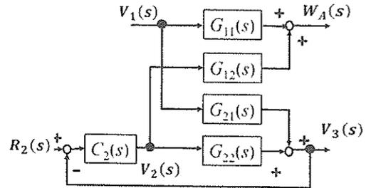
図VII-2 一方のフィードバック制御ループだけを閉じた系のブロック線図
