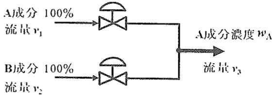
図VII-1 液体混合パイプライン
